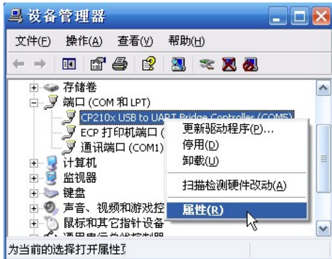
图2：指向usb虚拟出来的com5，点右键，察看属性
